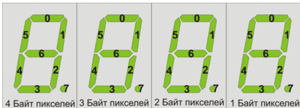
Схема раскладки битов (0-младший) по сегментам индикаторов
