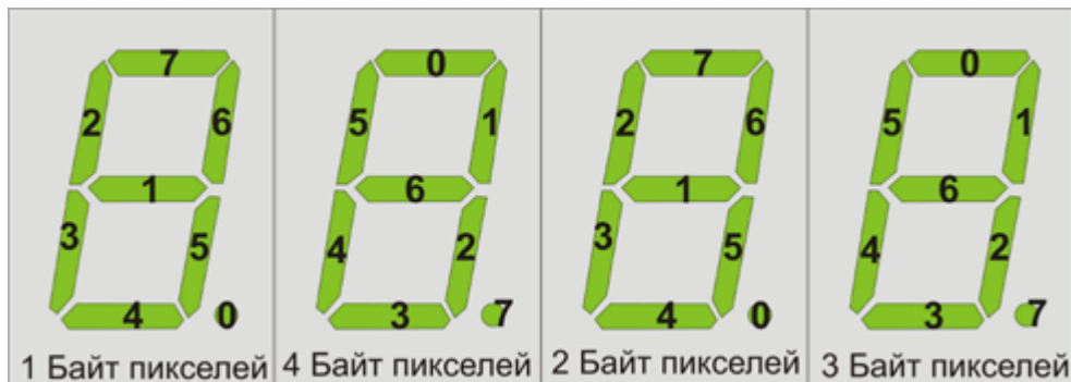
Схема раскладки битов (0-младший) по сегментам индикаторов
