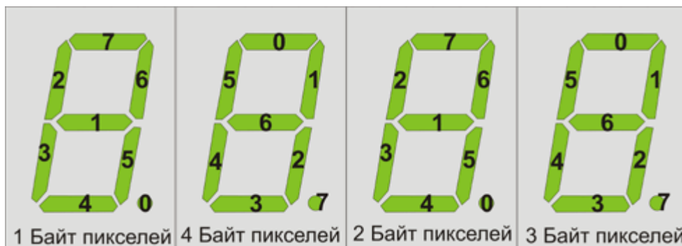
Схема раскладки битов (0-младший) по сегментам индикаторов
